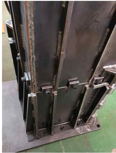
[ 그림 3-31 ] 보강재 용접 결합 모습
