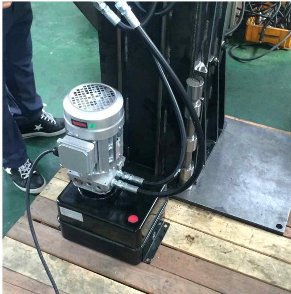
[그림 3-32] 유압펌프 조립된 모습
