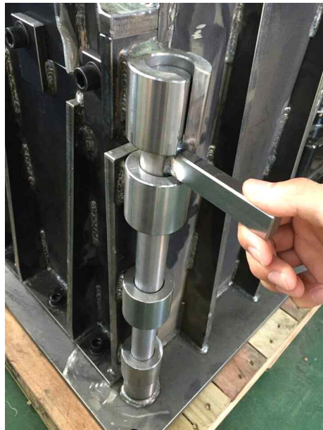
[그림 3-31] 잠금 장치 결합한 모습
