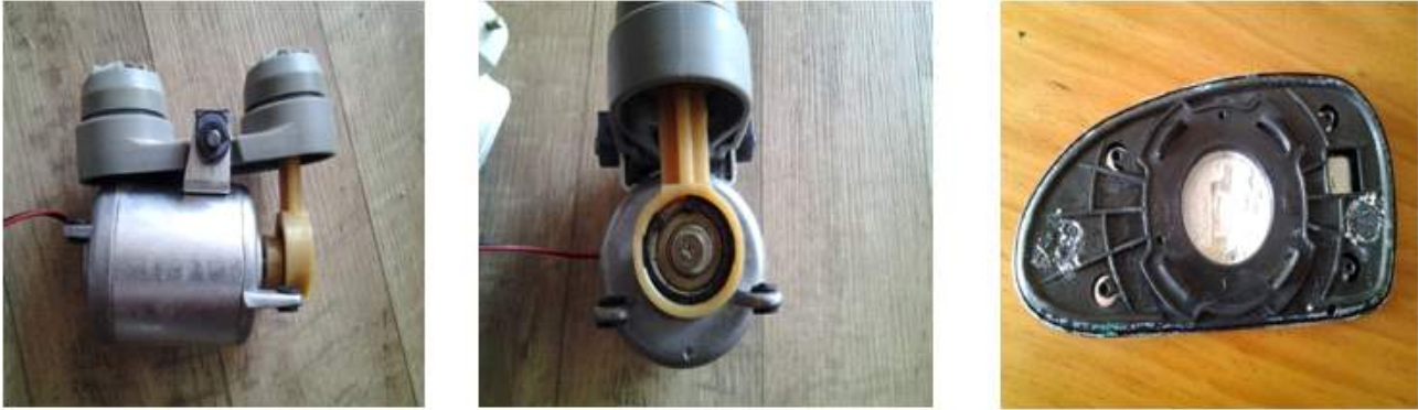
(그림4-5)안마기 속 모터를 분해한 모습
