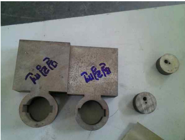
(그림5-3) WIRE처리된 처음 진동자 샘플
