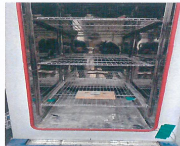
<Temp & Humidity Chamber와 내부모습>
