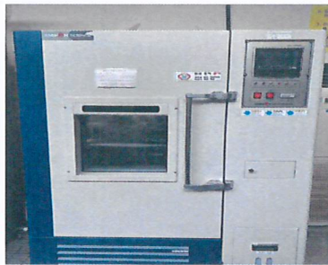
<Temp & Humidity Chamber와 내부모습>
